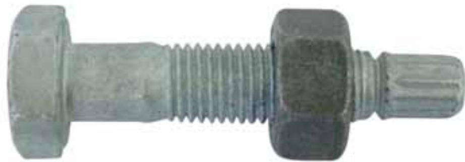
Skruv med tillhörande mutter enligt EN 14399-10 HRC-systemet.
