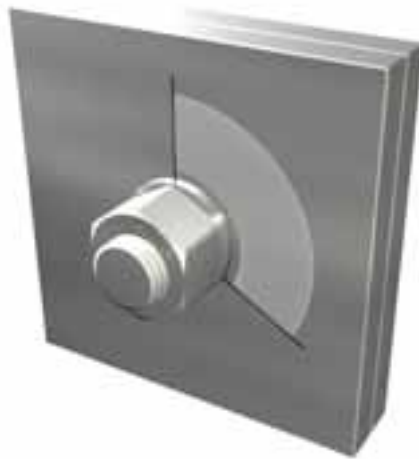
Vinkelvridning av mutter till 120 grader. Se tabell 4.
