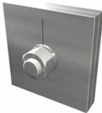
Lägesmarkering av mutter vid utförande av steg 2 i den kombinerade metoden.
